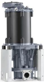
El motor acciona el rotor macho del elemento directamente, sin necesidad de utilizar engranajes, correas ni el retén del eje. Esto permite un conjunto de transmisión presurizado a través del cual el aceite fluye desde el motor al elemento. Su disposición vertical reduce sus dimensiones en un 60 %, por lo que resulta una máquina muy compacta.
