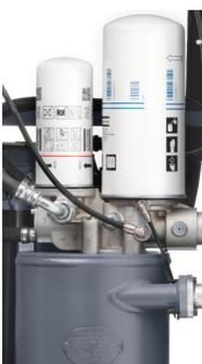
El sistema del separador de aire-aceite, de alta eficiencia, reduce el consumo de aceite garantizando unos costes de mantenimiento bajos y una buena separación de aceite entre dos intervalos de mantenimiento.
